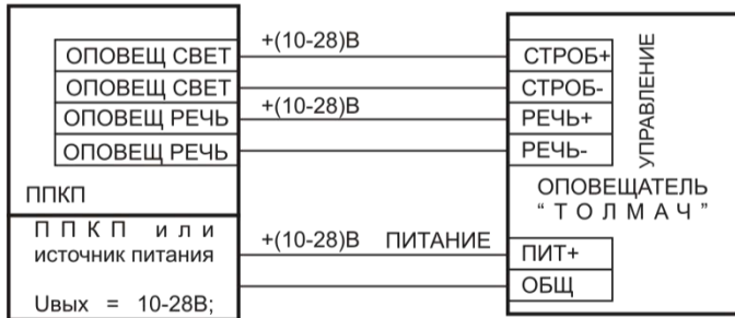
Рис. 3. Типовая схема подключения оповещателя «Толмач»П-Р с запуском по управляющему сигналу от ПКП.
