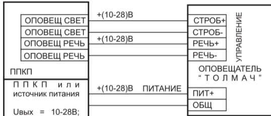
Рис. 2. Типовая схема подключения оповещателя «Толмач»Ex(m)-R с запуском по управляющему сигналу.
