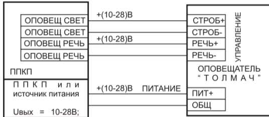
Рис. 2. Типовая схема подключения оповещателя «Толмач»Ex(m) с запуском по управляющему сигналу.
