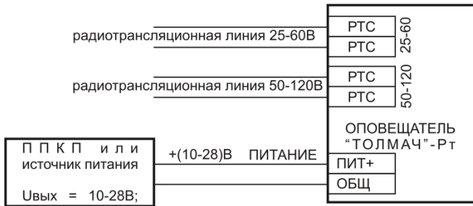
Рис. 1. Типовая схема подключения оповещателя «Толмач»Ex(m)-Pт с запуском по появлению напряжения радиотрансляционной сети.
